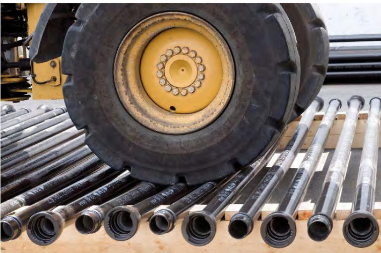
**Abbildung 2-3: Moderne duktile Gussrohre unter extremer Biegebelastung (Rammelsberg, 2016)**
