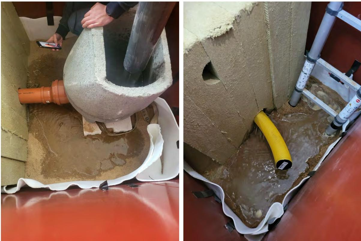
**Abbildung 5-8:** Einleitung des Wassers in die Rockflow-Elemente am Einlauf mit Rückstau (links) und am Ende der Elemente mit zusätzlichem Drainagerohr (rechts)
