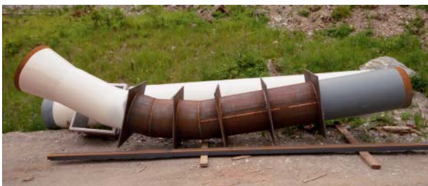
Bild 9: Exzentrischer Stahlkonus – Übergang von der Druckkammer des Entsanders zur Druckrohrleitung
