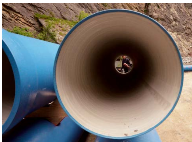
Bild 7: Duktile Gussrohre DN 800 mit Zementmörtel-Auskleidung
