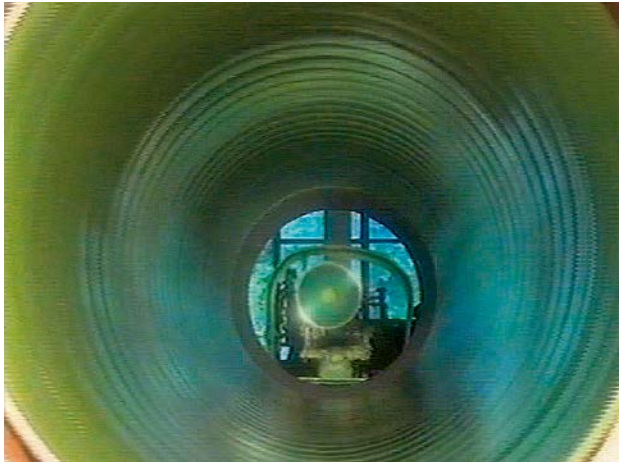
Bild 1: Spiegelglatte PUR-Innenbeschichtung, hydraulisch glatt mit einem Rauigkeitskoeffizient von k \leq 0,01 mm
