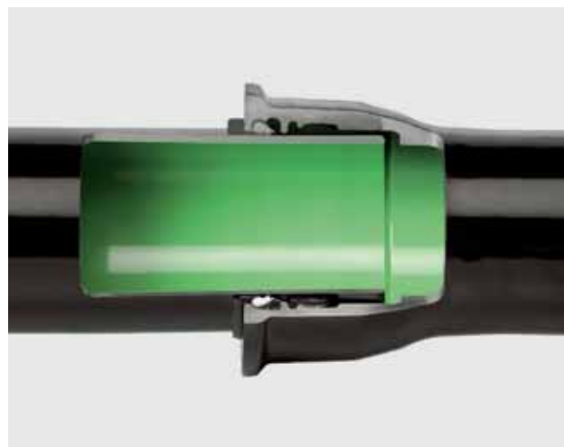
Bild 3: Innenliegende Schubsicherung des Systems hydroticht
