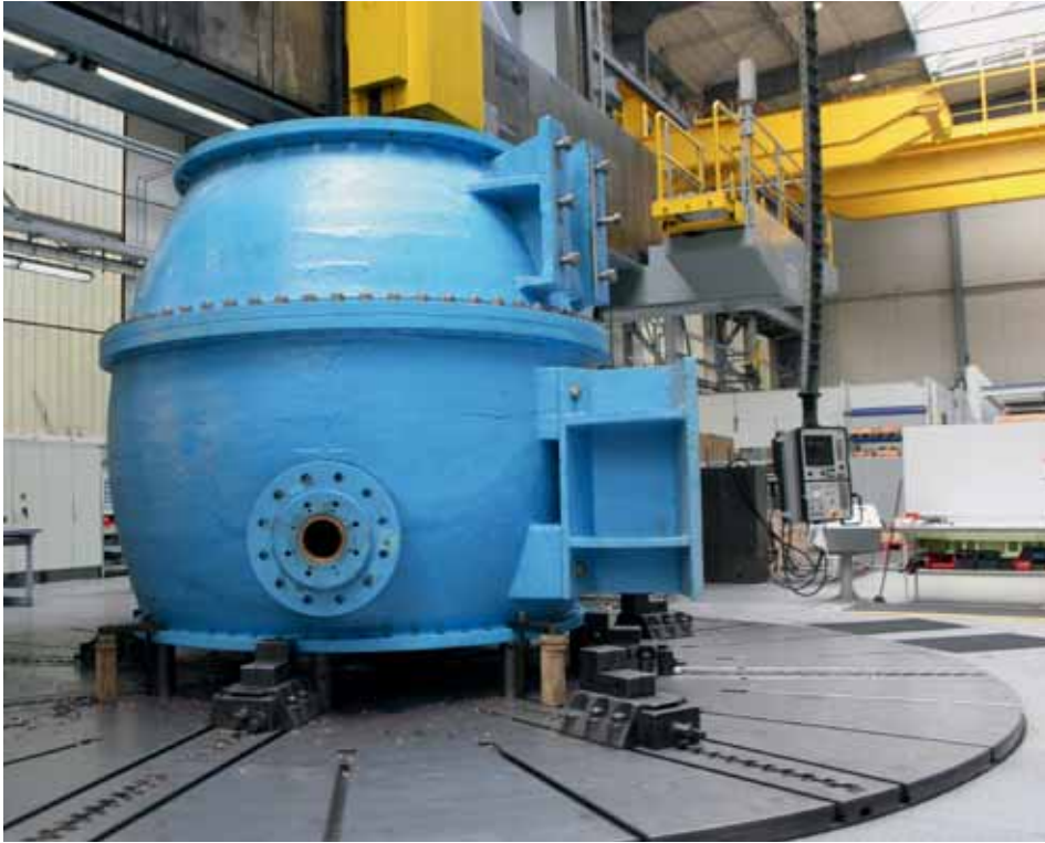
Bild 4: Bearbeitung der Innenkontur der Armatur auf einer Karussell-Drehmaschine
