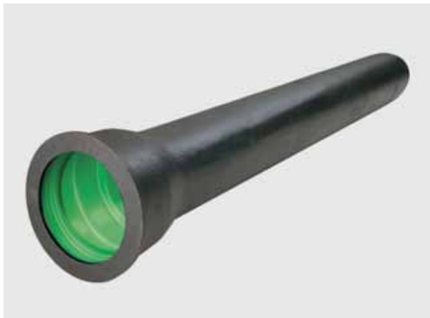
Bild 2: Duktiles Gussrohr mit Polyurethan-Auskleidung und Zinküberzug mit Bitumen-Deckbeschichtung
