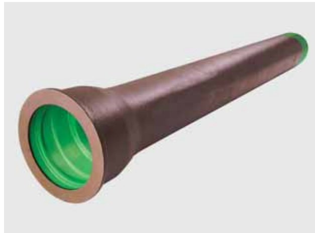
Bild 7: Duktiles Gussrohr mit Polyurethan-Auskleidung (PUR) und äußerem Zinküberzug mit bituminöser Deckbeschichtung
