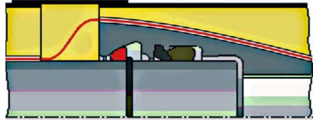
Bild 2 WKG- Rohr mit TIS-K-Verbindung und Begleitheizung
