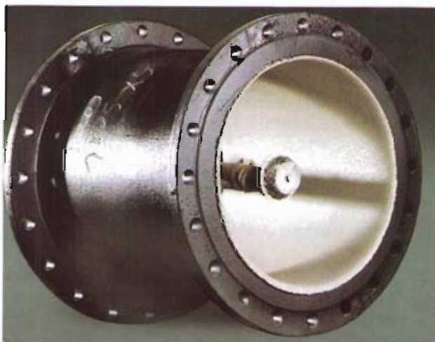
Bild 5: Auskleidung eines Formstückes im Radialspritzverfahren
