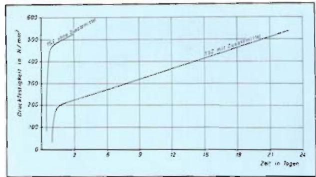
Bild 6: Erhärtungsverlauf von Zementauskleidungen auf Basis Tonerdeschmelzement, mit und ohne Zusatzmittel
