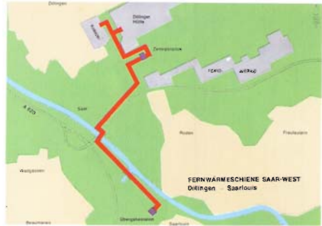
Bild 2: Lageplan mit Trassenverlauf
