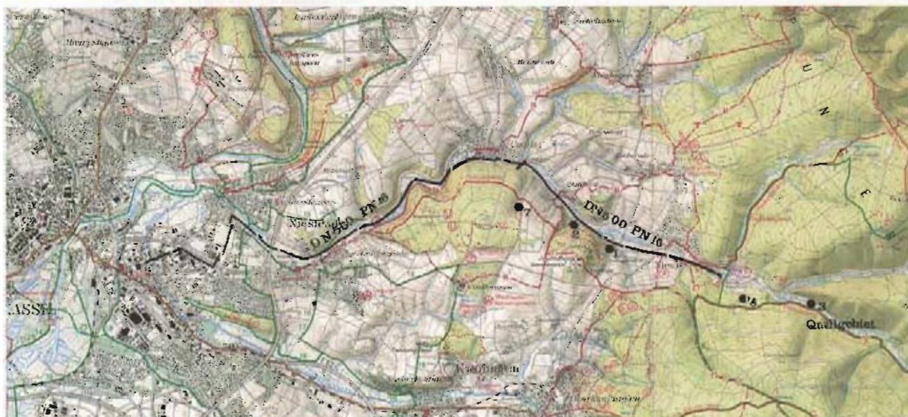
Bild 4: Trassenverlauf der Falleitung DN 500 aus duktilen Gußrohren
