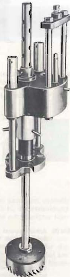
Bild 22 Anbohrgerät mit Preßluftantrieb; geeignet für Anbohrungen von 80 bis 500 mm mit Lochfräsern. Mit dem abgebildeten Gerät können Bohrungen bis 125 mm Durchmesser hergestellt werden. Bei größeren Bohrungen müssen speziell ausgeführte Blindflansche eingesetzt werden.
