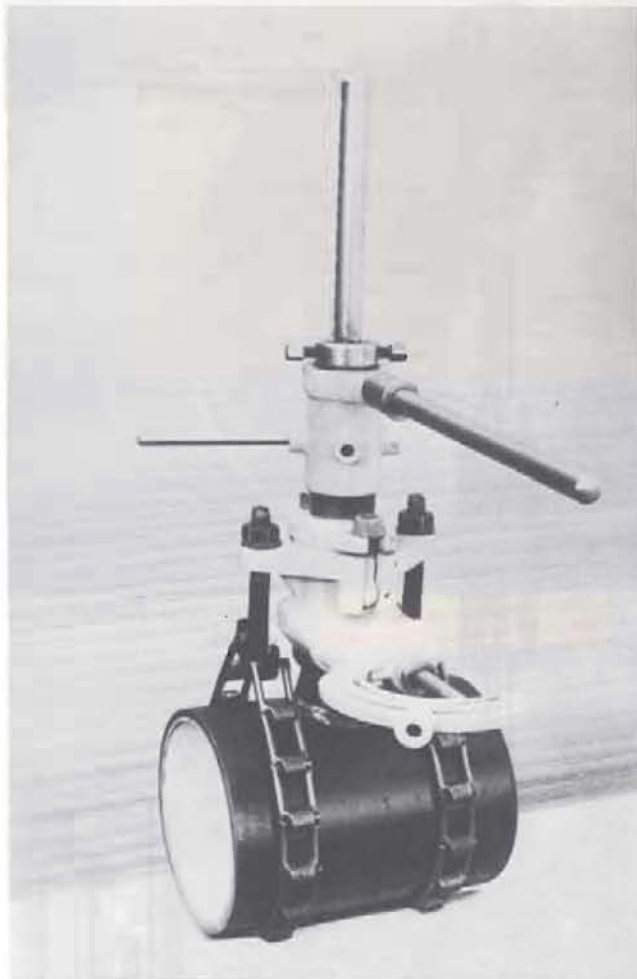
Bild 19 Anbohr-Apparat für Anbohrungen bis 2". Es können wahlweise Spiralbohrer oder Fräser eingesetzt werden. Mit diesem Gerät sind Anbohrungen an unter Innendruck stehenden Leitungen möglich.
