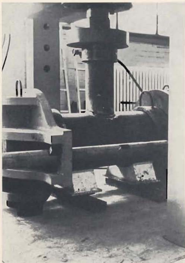
Bild 3: Berstversuch; Hauptrohr und Abgang mit übergreifenden Muffenkappen längskraftfrei abgedichtet
