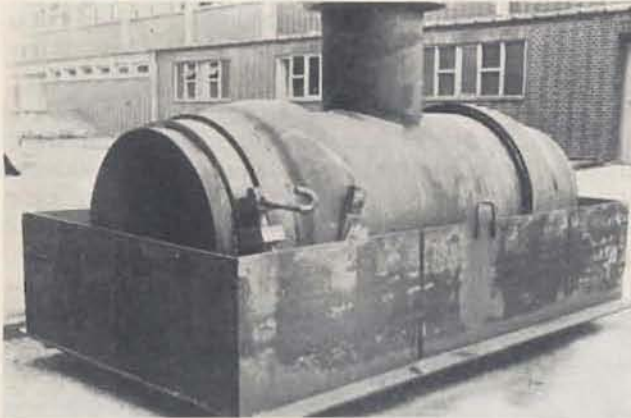
Bild 6: Einspannvorrichtung mit dem Prüfstück 8.4.5 beim Innendruckschwellversuch
