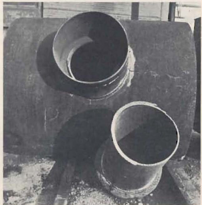
Bild 1: Prüfstück Nr. 10.3/4 nach dem Berstversuch; Rohrabschnitt NW 1000 mit Abgang NW 300 und Verstärkung durch einen Rohrabschnitt NW 400
