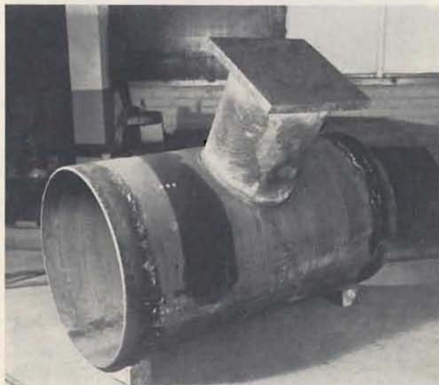
Bild 4: Prüfstück 8.4.2 nach dem Berstversuch; Abgang durch Abdeckung mit einer Stahlplatte längskraftbelastet
