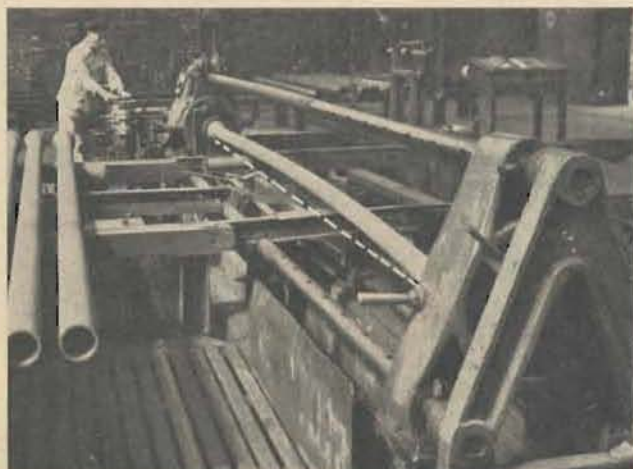
Bild 1: Rohr NW 80 mm, 5000 mm lg., aus Gußeisen mit Lamellengraphit (GG), elastisch durchgebogen
