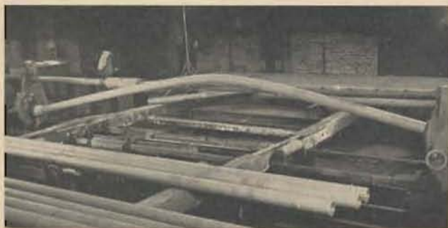
Bild 2: Rohr NW 80 mm, 5000 mm lg., aus duktilem Gußeisen (GGG) durchgebogen
