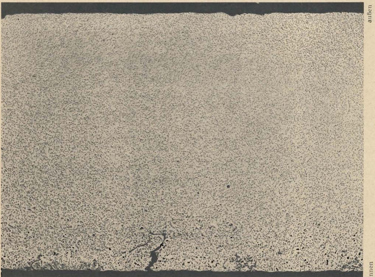
Bild 1: Polierter Längsschnitt durch die Wand eines duktilen Gußrohres (Original-Vergrößerung V = 20 )
