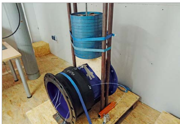
Figure 16: Test set-up for a DN 400 TYTON® push-in joint based on EN 14741 [13] at the IRO Institut für Rohrleitungsbau an der Fachhochschule Oldenburg e. V.
