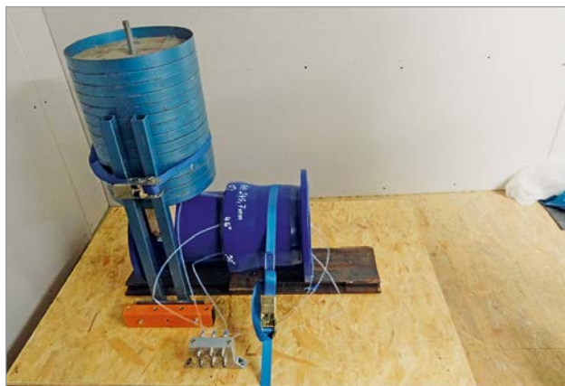
Figure 15: Test set-up for a DN 200 TYTON® push-in joint based on EN 14741 [13] at the IRO Institut für Rohrleitungsbau an der Fachhochschule Oldenburg e. V.
