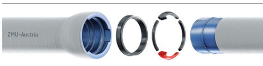
Natürlich lassen sich ZMU-Austria-Rohre ebenso einfach mit den bewährten Verriegelungssegmenten sichern. Spitzende und Muffenbereich bleiben dabei frei von der ZM-Umhüllung.
