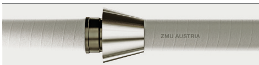
Für den zusätzlichen Schutz der Muffen empfiehlt sich beim grabenlosen Einbau ein spezieller Blechkonus.
