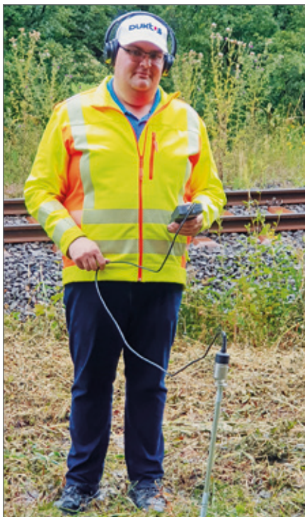
Bestätigung der Messergebnisse vor Ort mittels Bodenmikrofon.
