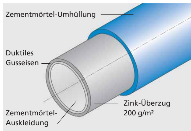
Bild 1: Zementmörtel-Umhüllung nach DIN EN 15542 [1]
