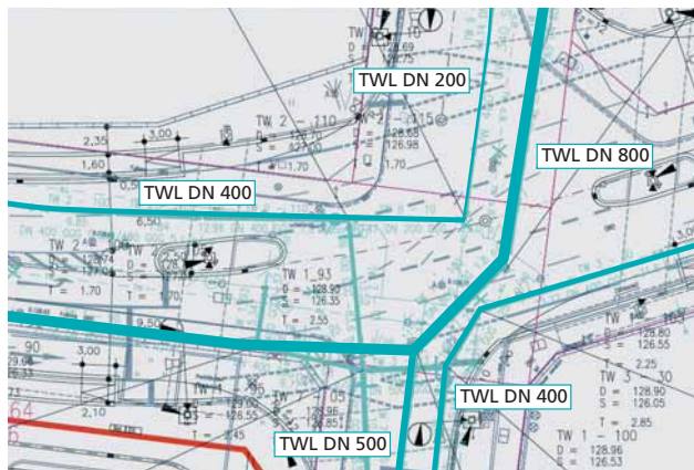
Bild 5: Belegung des unterirdischen Bauraums
