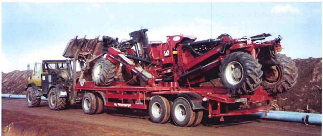
Bild 2: Rohrflug mit Zugfahrzeug
