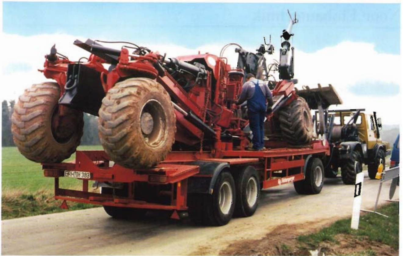
Bild 2: Rohrpfug mit Zugmaschine
