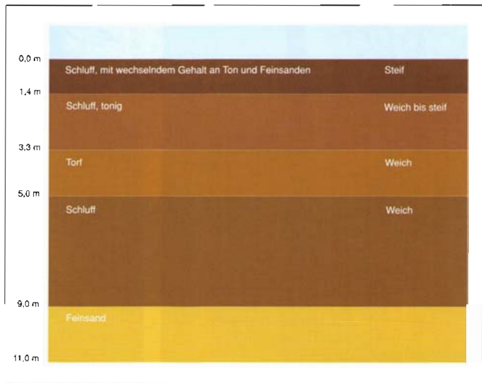
Bild 1: Verteilung der Bodenarten im Raum Emden
