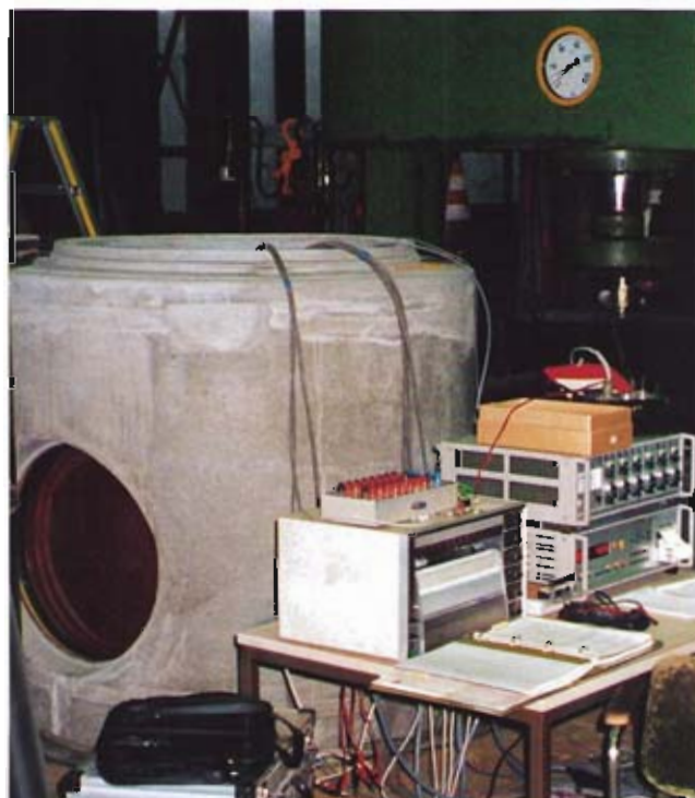
Bild 3: Meßstand zur Erfassung und Auswertung von Daten der Dehnungs- und Verformungsaufnehmer
