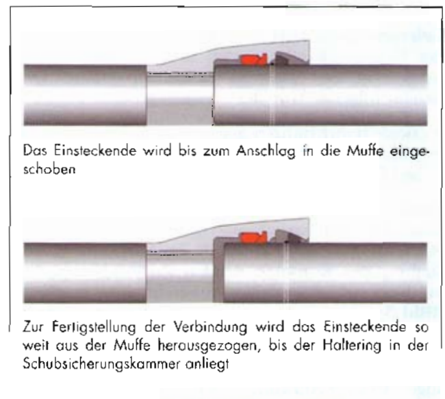
Bild 6: Montage der längskraftschlüssigen Steckmuffenverbindung TIS-K
