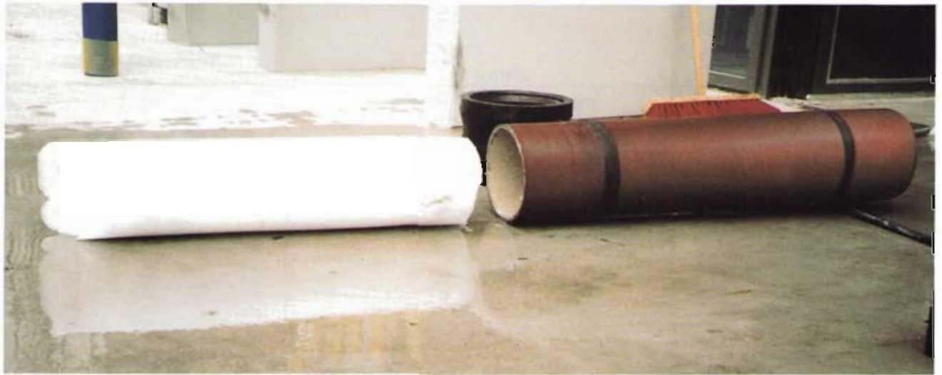
Bild 4: Rohrabschnitt mit gelöstem Eispfropfen
