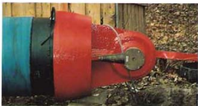
Bild 5: Zugadapter mit Kraftmeßdose
