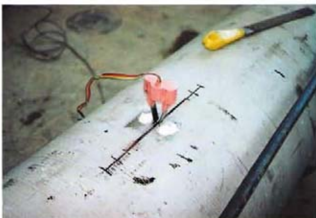
Bild 4: Applikation des Rißweitemaufnehmers
