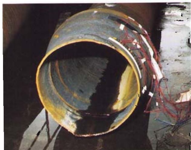
Bild 9: Schubsicherung TKF DN 400 unversehrt nach 140 bar Berstdruck
