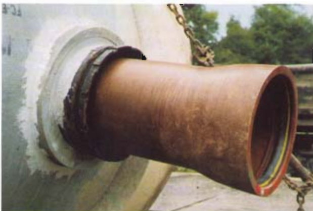
Bild 7: Rohranschluß mit Schraubmuffe
