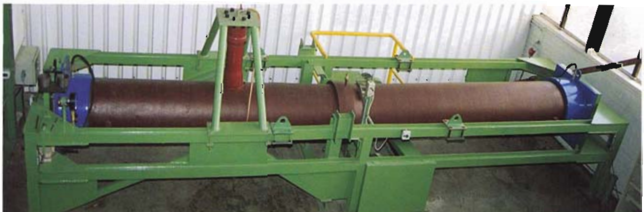
Bild 3: Prüfeinrichtung für TYTON-Muffenverbindungen
