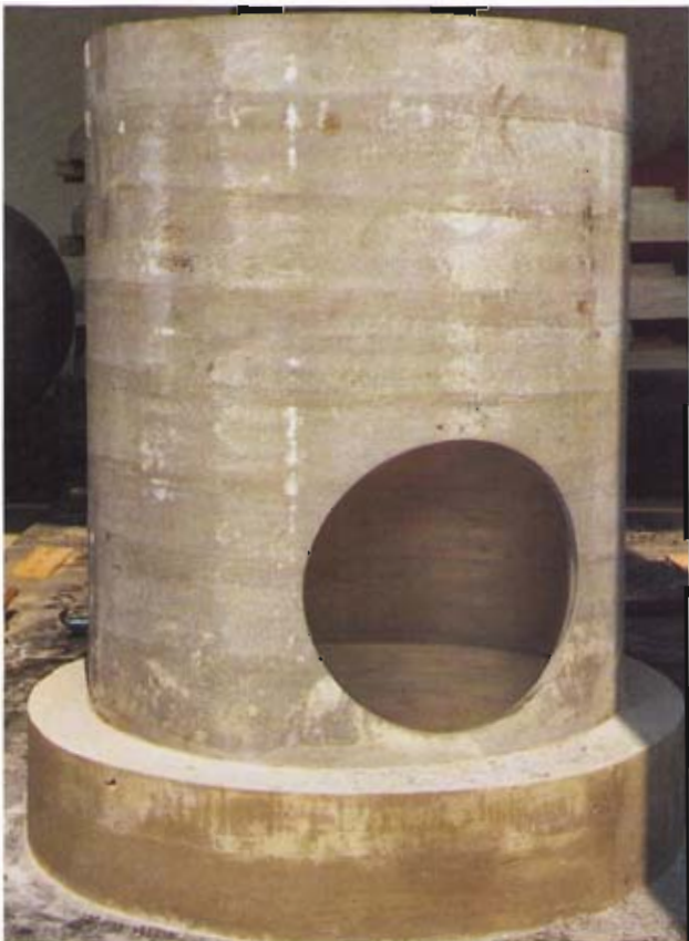
Bild 4: FZ-Schacht in der Fertigung
