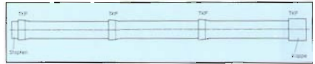
Bild 6: Versuchsaufbau zur Prototypenerprobung DN 400
