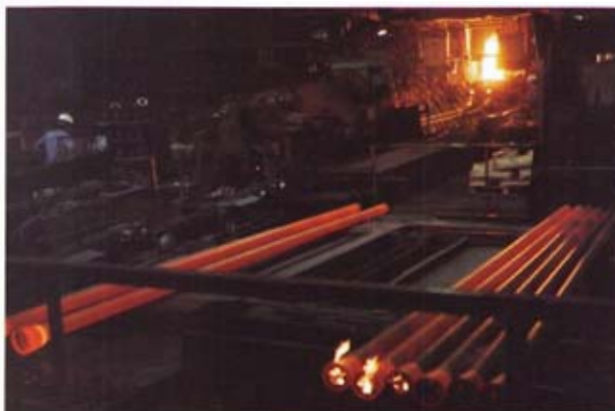
Bild 4: Beschicken der Schleudergießmaschine im Hintergrund und vorn die fertigen, noch glühenden Rohre
