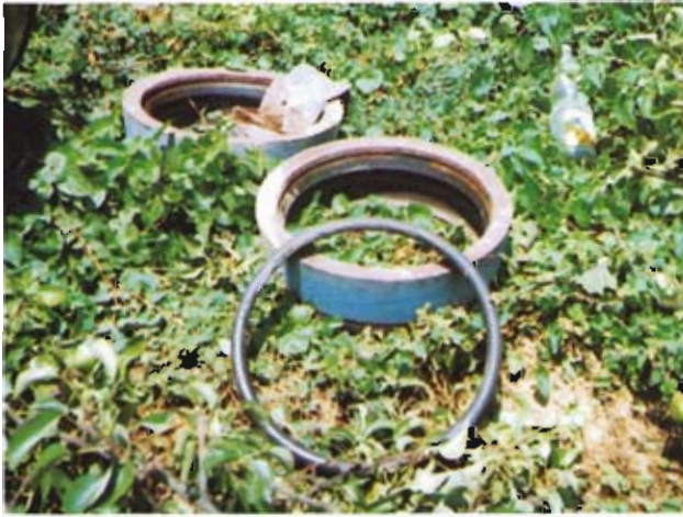
Bild 6: Schachtanschlußstück mit Dichtring
