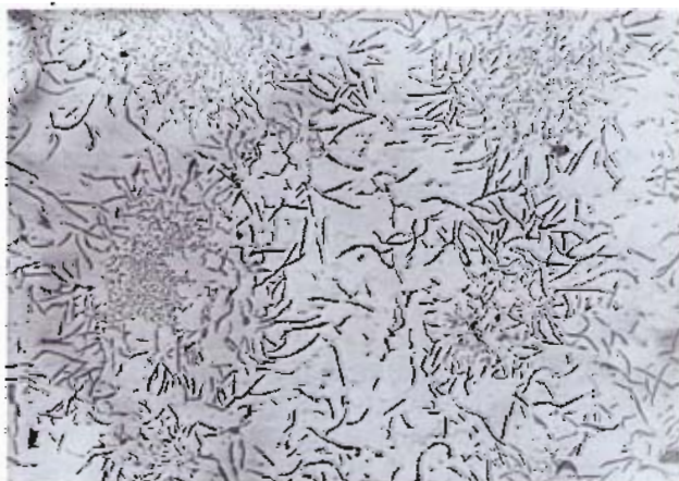
Bild 2: Querschnitt durch die Grauguß-Rohrwand mit innerer und äußerer Spongiose; Anteil an noch tragender Wand ca. 20 %
