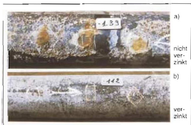
Bild 12: Vernarbung von 3 Schlagstellen an einem verzinkten Rohr aus duktilem Gußeisen (b) im Vergleich zum Effekt der gleichen Verletzung an einem nicht verzinkten Rohr (a). Proben 6 Jahre im Versuchsfeld Mont-Saint-Michel
