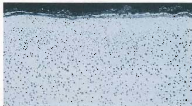
Bild 20: Aufgrabung Beuren Das Zink wurde teilweise in Zinkkorrosionsprodukte umgewandelt.
