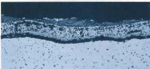
Bild 16: Schliff durch die Deckschicht Aufgrabung Sarralbe
