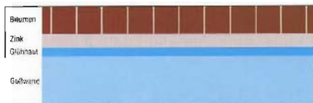
Bild 1: Aufbau des Zinküberzugs mit Deckbeschichtung
