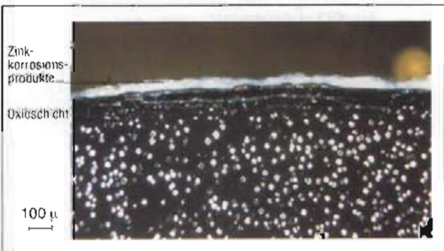
Bild 5: Schliff durch die Deckschicht aus Zinkkorrosionsprodukten. Aufnahme unter polarisiertem Licht. Versuchsfeld Lesmenils, Versuchsperiode 1968 bis 1978
