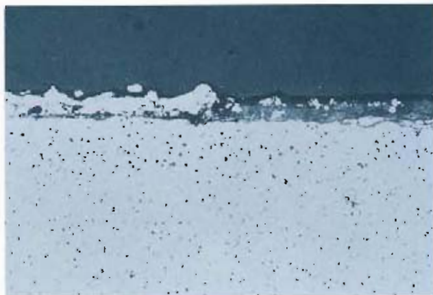
Bild 2: Deckschicht aus Zinkkorrosionsprodukten Die Schichtdicke in den Bereichen, in denen das Zink mehr bzw. weniger umgesetzt ist, blieb die gleiche.
