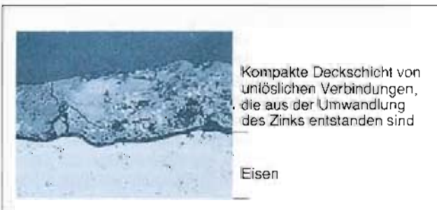
Bild 4: Schliffaufnahme ( \times 250 ) durch die Deckschicht auf einem Rohr aus duktilem Gußeisen, das 19 Jahre lang in stark aggressivem Boden bei Mont-Saint-Michel gelegen hat
