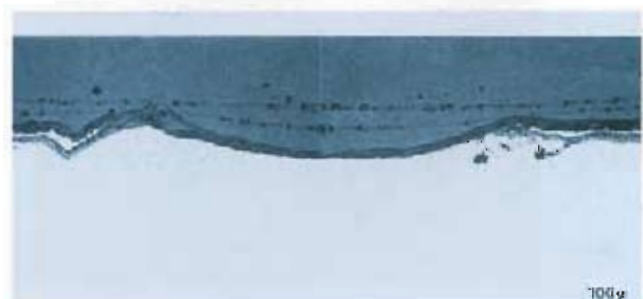
Bild 10: Schnitt durch die vernarbte Verletzung der verzinkten Probe von Bild 5. Probe lag 1 Jahr in einer M/10 NaCl M/100 Na 2 SO 4 -Lösung.
