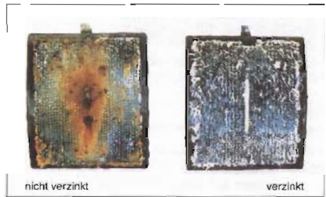
Bild 9: Vernarbung einer Verletzung; Laborversuch linke Probe nicht verzinkt rechte Probe verzinkt Proben lagen 1 Jahr in einer M/10 NaCl M/100 Na 2 SO 4 -Lösung.
