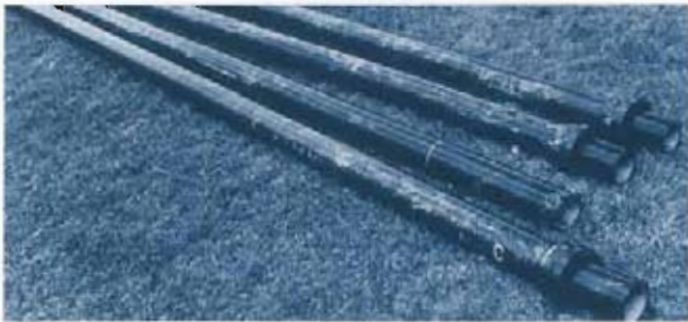
Bild 15: Rohre aus duktilem Gußeisen aus der Aufgrabung Sarralbe nach 5 Jahren Liegezeit
