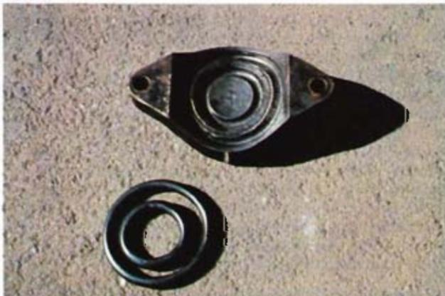
Bild 9: Anbohrschellen-Oberteil mit Doppeldichtung
