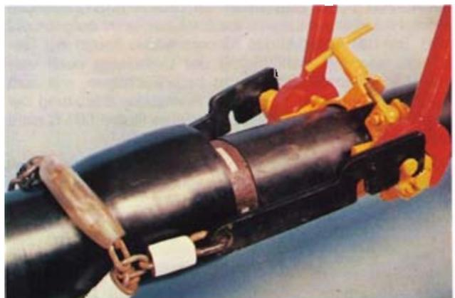
Bild 3: Verlegegerät V300K für Polyethylen-umhüllte Rohre
