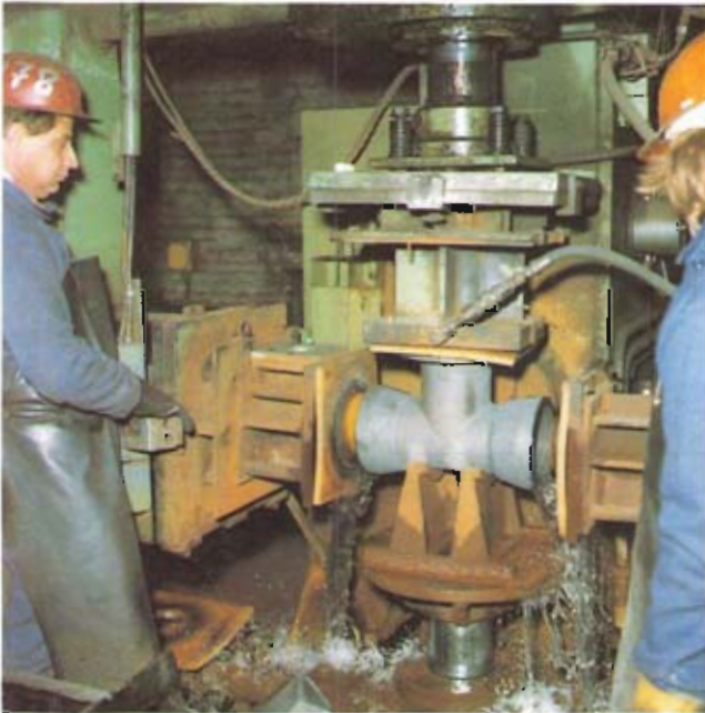
Bild 17: Dichtheitsprüfung eines Abzweigstückes
