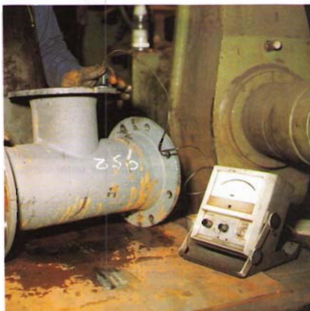
Bild 14: Duktilitätskontrolle am Formstück
