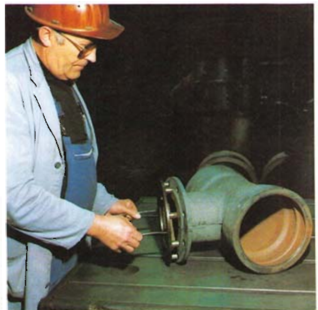
Bild 16: Prüfen der Winkelabweichung von Schraubenlöchern mit Grenzlehren
