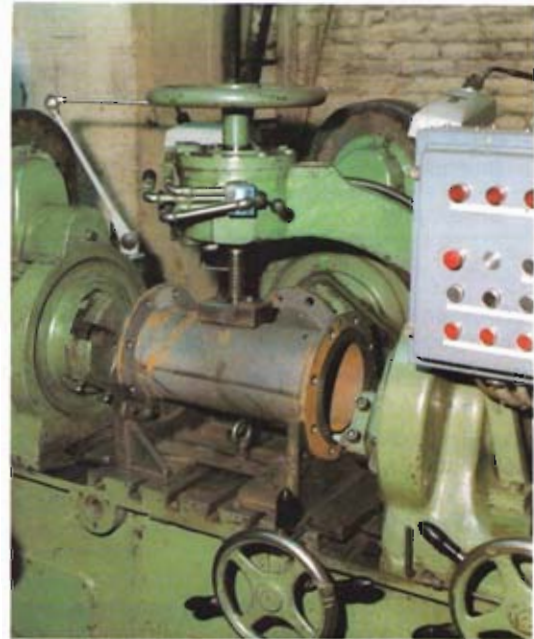
Bild 12: Bearbeitung der Dichtleisten eines T-Stückes
