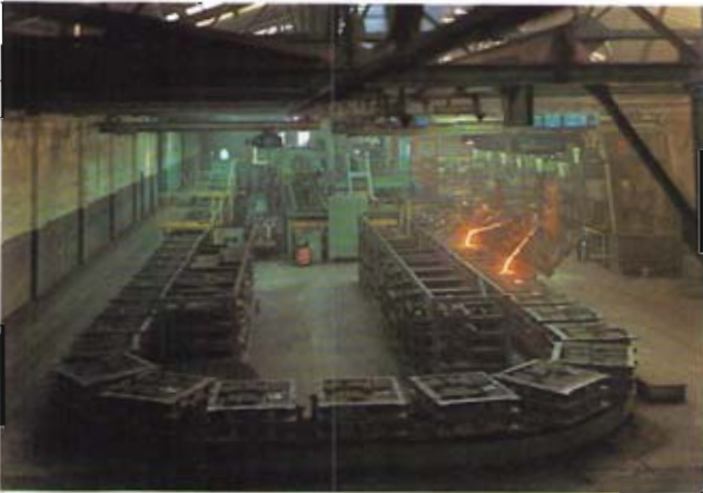
Bild 10: Formanlage zur Herstellung von Formstücken stoffe sind dem Herstellungsverfahren angepaßt. Die gleichbleibende Qualität der Abgüsse wird u. a. durch eine regelmäßige Kontrolle der Form- und Hilfsstoffe gesichert (Bild 11).
