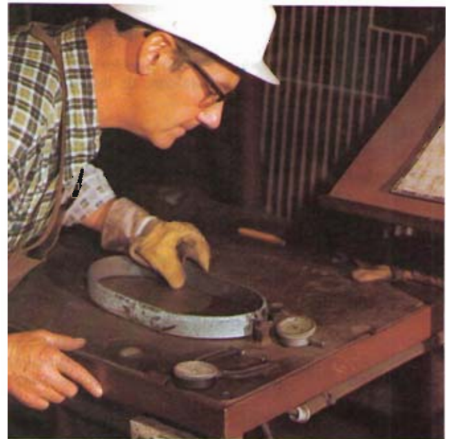
Bild 7: Ausmessen der Ringfaltprobe
