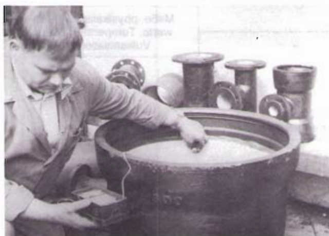
Bild 18: Zerstörungsfreie Schichtdickenmessung bei einem mit Zement-Kunststoffmörtel ausgekleideten Formstück
