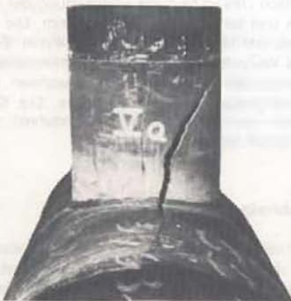
Bild 3: Rißverlauf an einem geborstenen Versuchsstück DN 800/DN 400
