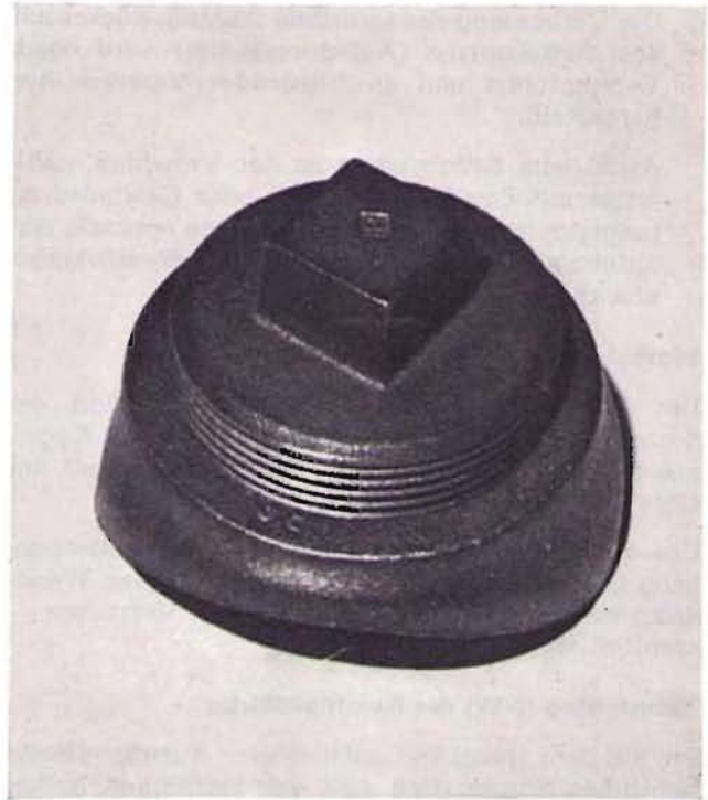
Bild 3: Aufschießbarer Sattelstutzen (Hauptrohr NW 100, Stutzenöffnung NW 50) mit Einschweißstopfen
