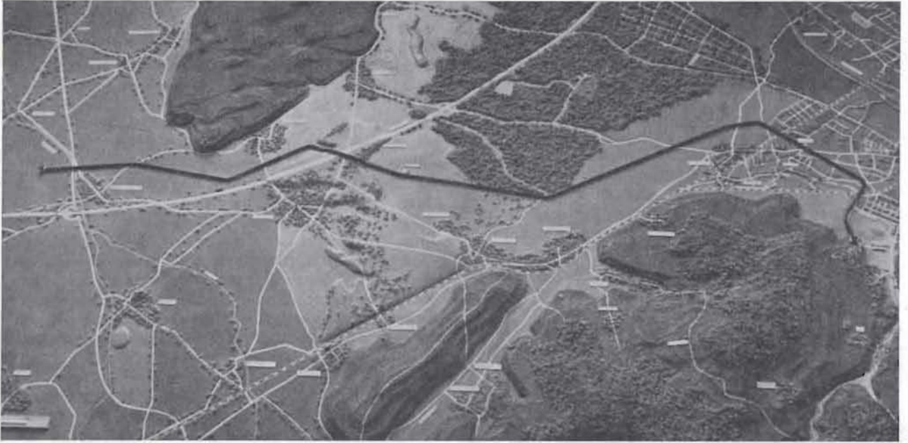
Leistungsmodell Wasserversorgung Hausen - Freiburg (NW 800 und 1000) mit dem neuen Wasserwerk Hausen am Anfang und dem 20 000 cbm großen Gegenbehälter im Stadtgebiet
