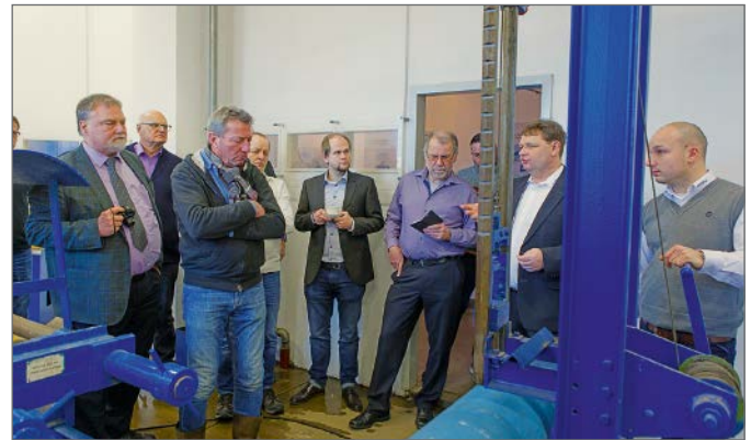
Vorführung des Fallversuchs zur Prüfung der Widerstandsfähigkeit der Zementmörtel-Umhüllung.
