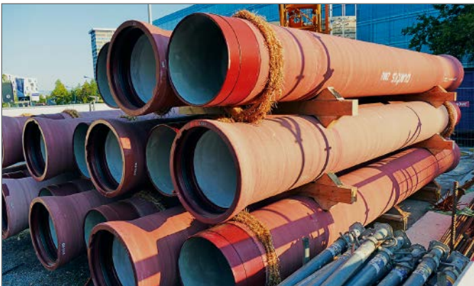
Duktile Gussrohre DN 600 nach EN 598 [1] mit Zementmörtel-Umhüllung (ZM-U) von Hagenbucher/Duktus.
