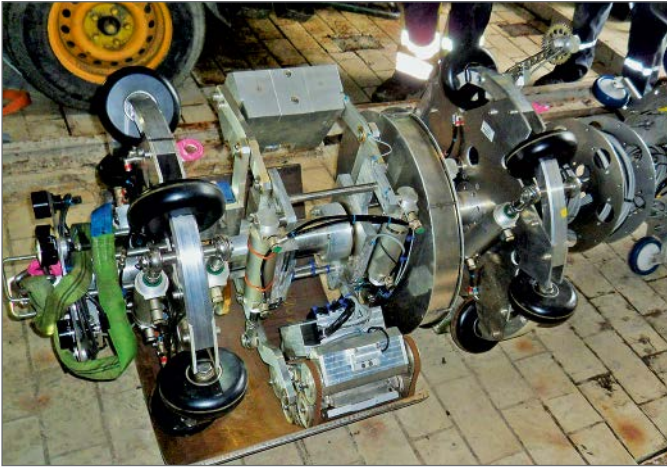
Der SLOFEC® Internal Pipe Scanner Typ PLS.
