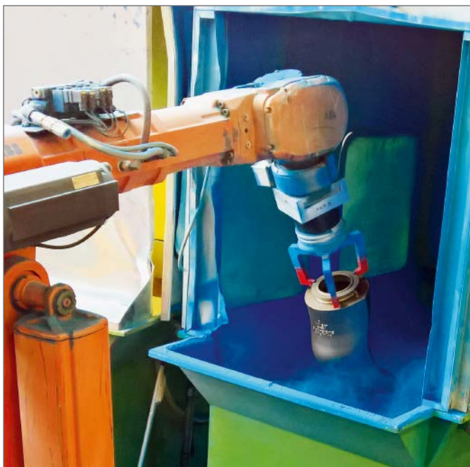
Beschichtung durch Wirbelsinternverfahren
