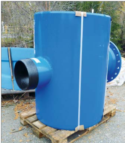
Nachträglicher Einbau eines Schachts mit Spülmöglichkeiten an einem Tiefpunkt der Kraftwerksleitung (Mannloch)
