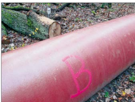
Nach der Entfernung der Eiche war weder eine Beschädigung noch eine Veränderung an der Umhüllung erkennbar
