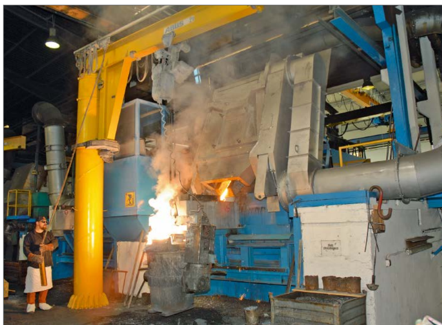
Fünf-Tonnen-Mittelfrequenz-Induktionsofen (Quelle: Ludwig Frischhut GmbH & Co. KG)
