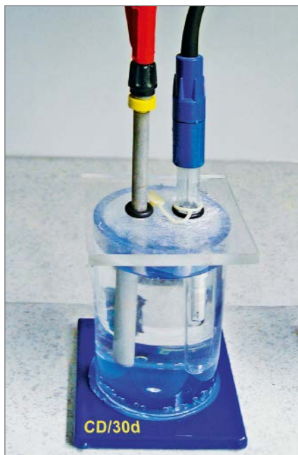
Prüfung der kathodischen Unterwanderung
