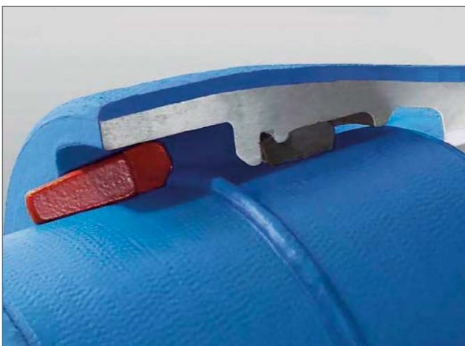
Formschlüssige und längskraftschlüssige Muffen-Verbindung VRS®-T mit Schweißbraupe, Teil des Muffenfensters, Verriegelungselement (rot) und Sicherungskammer
