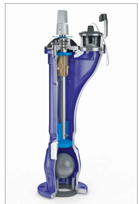
Unterflurhydrant DN 80: doppelte Absperrung, Öffnungsrichtung entgegen der Strömungsrichtung – Vollmaillierung
