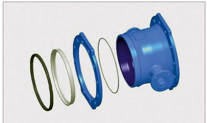
Aufbau der Absperrklappe ERHARD ROCO wave mit Losflansch: (v.l.n.r.) Dichttring als Flanschdichtung (EPDM), Haltering (nichtrostender Chromstahl 1.4301), Losflansch (EKB-beschichtet), O-Ring, Fester Flansch
