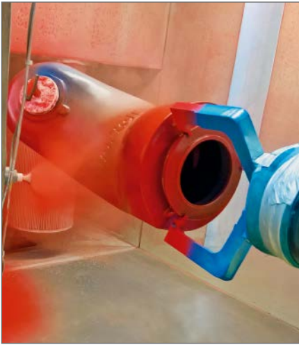
Aufbringen eines Polyesterpulvers als Deckschicht auf eine Epoxidharz-Beschichtung mittels elektrostatischem Sprühverfahren
