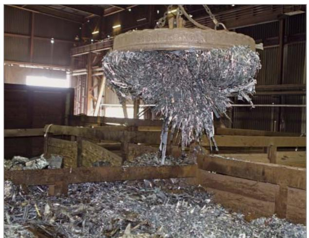
**Bild 7:** Verwendung von Stahlschrott für die Produktion von duktilem Gusseisen
