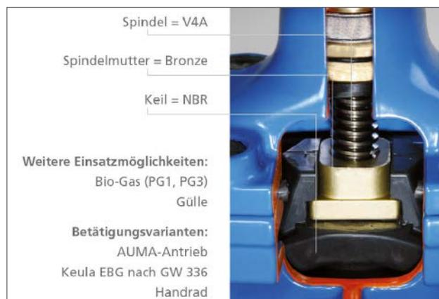
**Bild 2:** Schnittdarstellung eines Absperrschiebers aus duktilem Gusseisen
