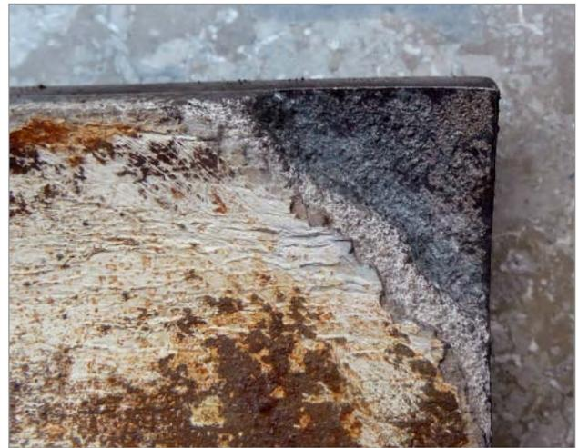
**Bild 3:** Gussrohrabschnitt mit partiell abgetragener Zementmörtel-Auskleidung
