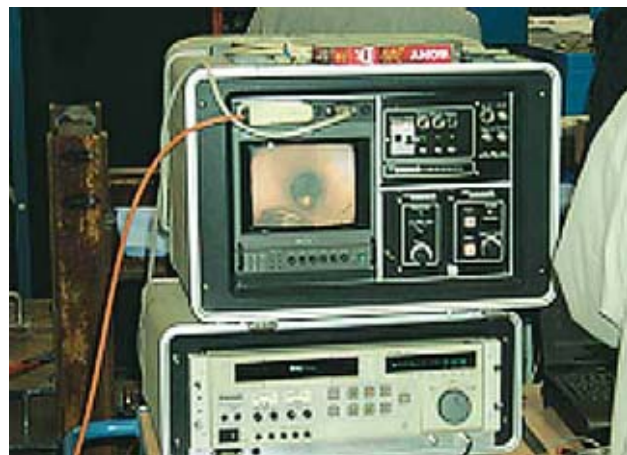
Bild 12: TV-Kamerakontrolle der ZM-Auskleidung während der Belastung
