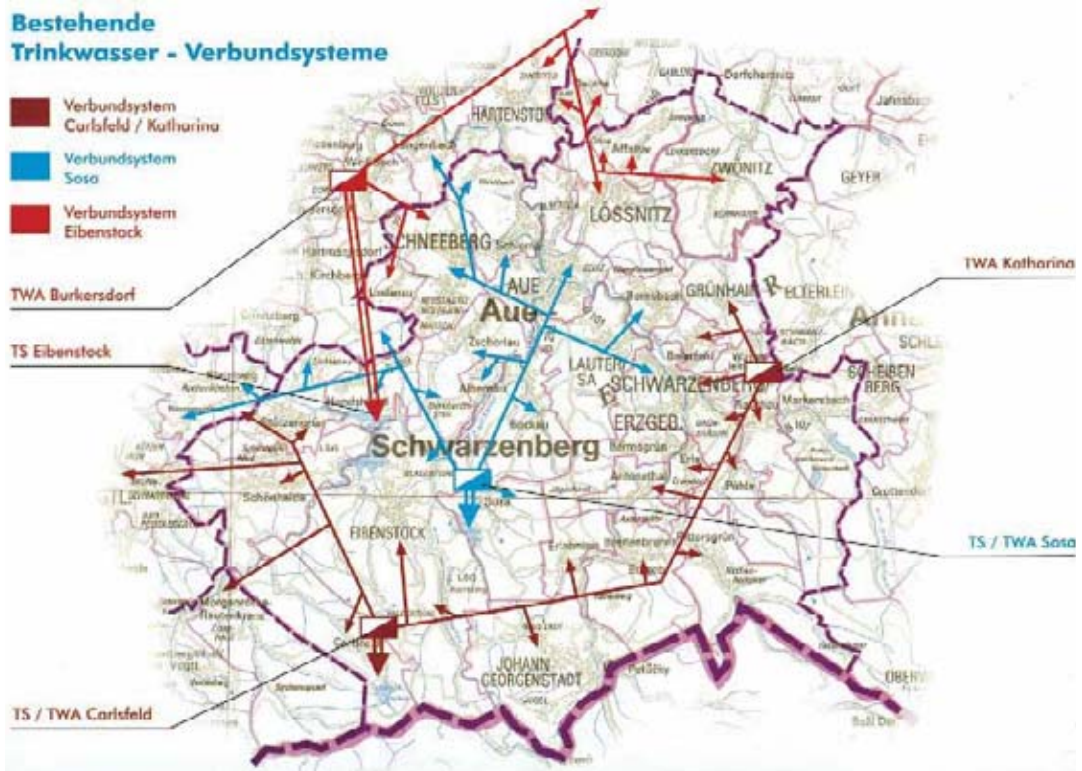
Bild 3: Übersichtsplan der Leitungs- netze
