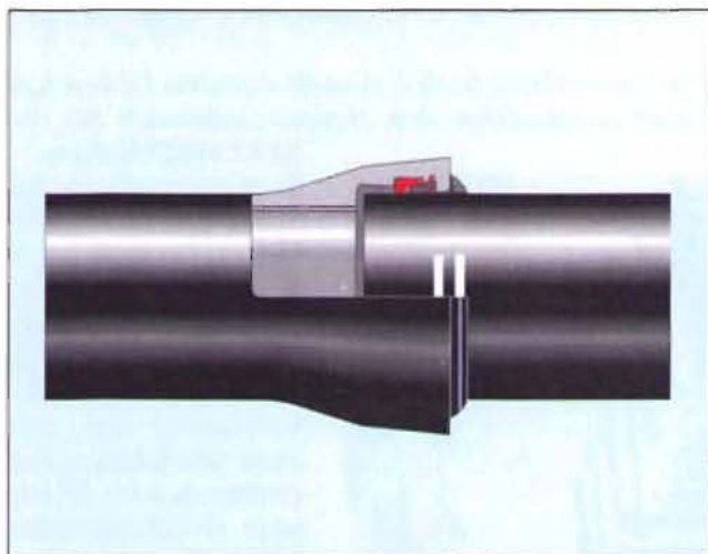
Bild 1: Längskraftschlüssige Verbindung TYTON-SIT®
