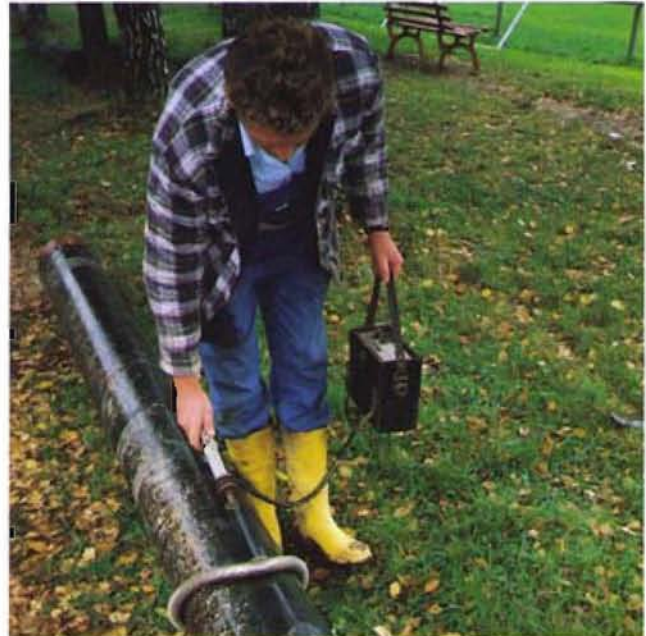
Bild 3: Funkenprüfung mit 5 kV nach Anlieferung
