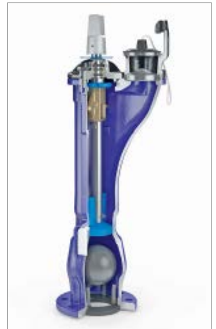
Unterflurhydrant doppelte Absperrung mit Vollemaillierung, Öffnungsrichtung entgegen der Strömungsrichtung
