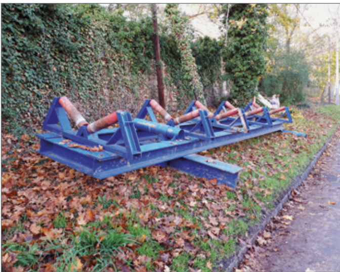
Abb. 8: Montagerampe für die Rohre. (Quelle: vonRoll hydro (deutschland) gmbh & co kg, Wetzlar)
