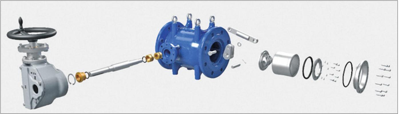
Explosionsdarstellung des Ringkolbenventils Typ 7015: Körper aus Gusseisen mit Kugelgraphit; Regelzylinder und Schubkurbelgetriebe aus Edelstahl, Edelstahlschrauben sowie Laufbuchsen aus Messing.
