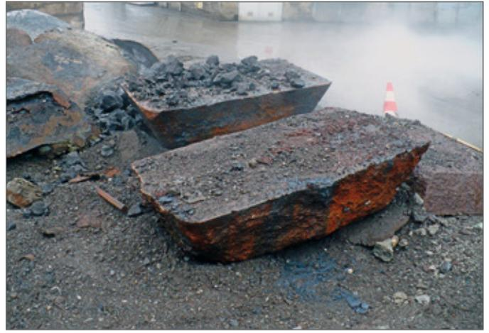
Spüleisen. Links: Nach der Entnahme, während des Abkühlens. Rechts: Erkalte Gussblöcke.
