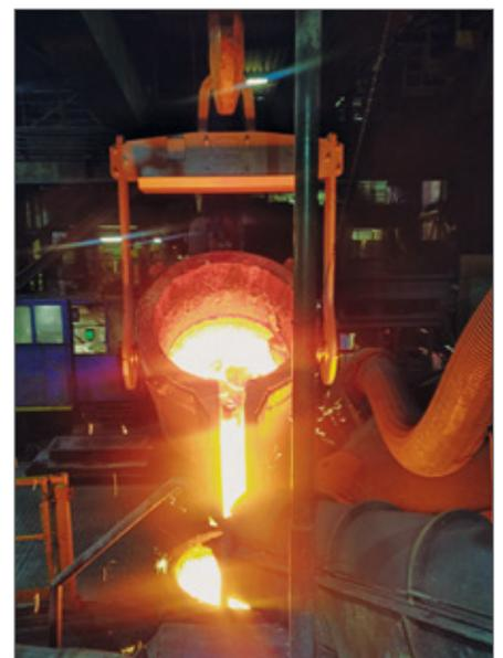
Spüleisenrückführung mit zusätzlichen Pfannen und ergänzter Anlagentechnik. Links: Befüllen einer Pfanne. Mitte: Transport des noch flüssigen Spüleisens zum Vorherd. Rechts: Rückführung in den Vorherd und Einsatz im Fertigungsprozess.
