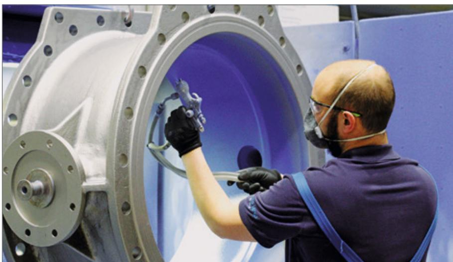
Emaillierung als hervorragender und dauerhafter Korrosionsschutz.
