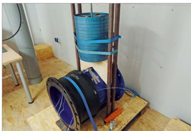
Bild 16: Prüfaufbau für eine TYTON® - Steckmuffen-Verbindung DN 400 in Anlehnung an EN 14741 [13] beim IRO „Institut für Rohrleitungsbau an der Fachhochschule Oldenburg e. V.“
