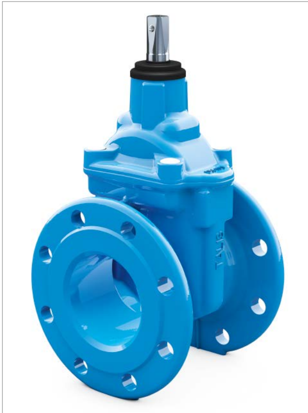
Bild 8: INFINITY ohne Handrad – kurze Ausführung R14 entsprechend EN 558 [3] mit Epoxidharz-Pulver- Beschichtung
