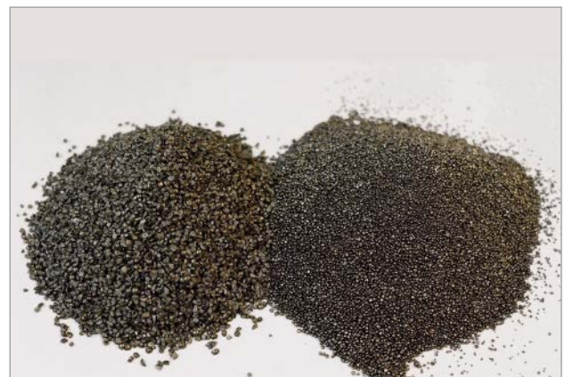
Bild 1: Äußerlich erkennbarer Unterschied scharfkantigen Originalstrahlmittels (links) im Vergleich mit gebrauchtem, „arrondiertem“ Strahlmittel (rechts)
