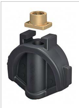
Bild 7: Vollgummierter Keil in EPDM- oder NBR-Qualität – Keilführung mit anvulkanisierter U-Schiene aus Sonderkunststoff – Spindelmutter lose eingelegt
