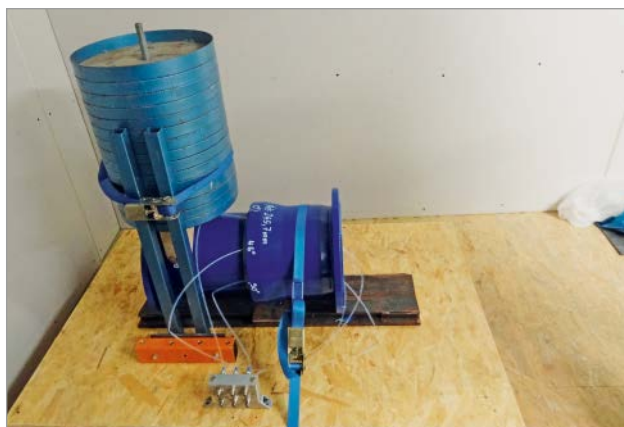
Bild 15: Prüfaufbau für eine TYTON® - Steckmuffen-Verbindung DN 200 in Anlehnung an EN 14741 [13] beim IRO „Institut für Rohrleitungsbau an der Fachhochschule Oldenburg e. V.“
