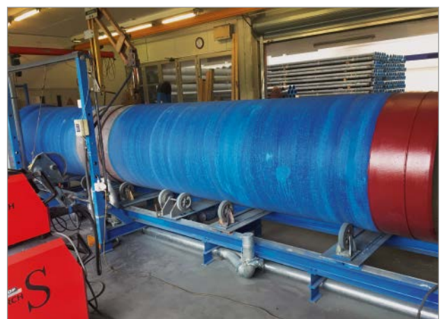
Bild 4: Konfektionierung der Passrohre im Hagenbucher-Kompetenz-Zentrum in Eglisau
