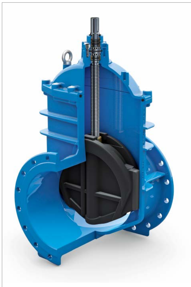
Bild 2: Schnittbild – Ausführung eines zusammengebauten Schiebers INFINITY für die Nennweiten DN 350 bis DN 600
