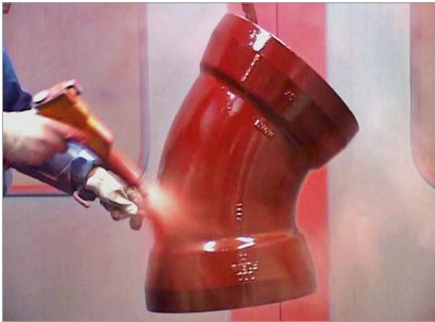
Bild 2: Manuelles Beschichtungsverfahren mittels Elektrostatikpistole – unmittelbares Schmelzen des Pulvers auf dem heißen Untergrund führt zu kontinuierlichem Filmaufbau
