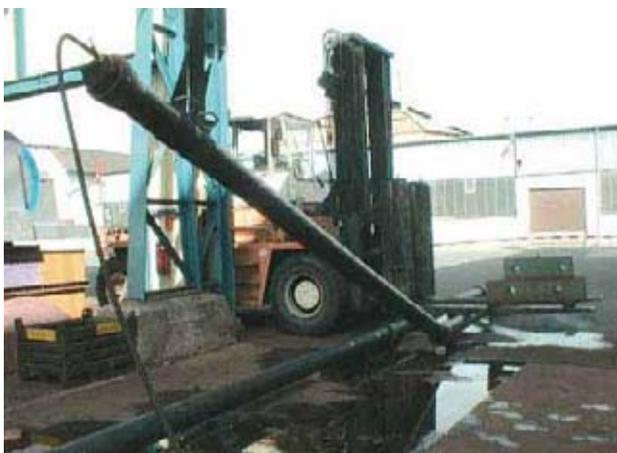
Bild 8: BLS-Verbindung mit Klemmring
