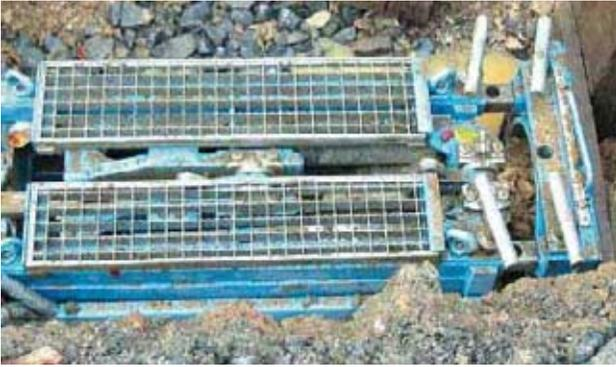
Bild 5: Zugmaschine
