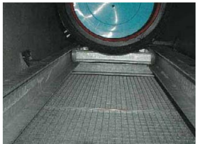
Bild 5: Auflagerkonstruktion mit Führungsrollen
