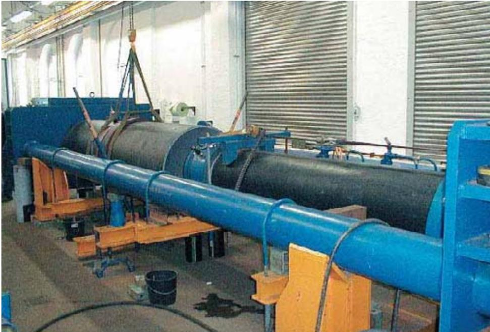
Bild 3: Versuchseinrichtung zur Bestimmung der zulässigen Einschubkräfte
