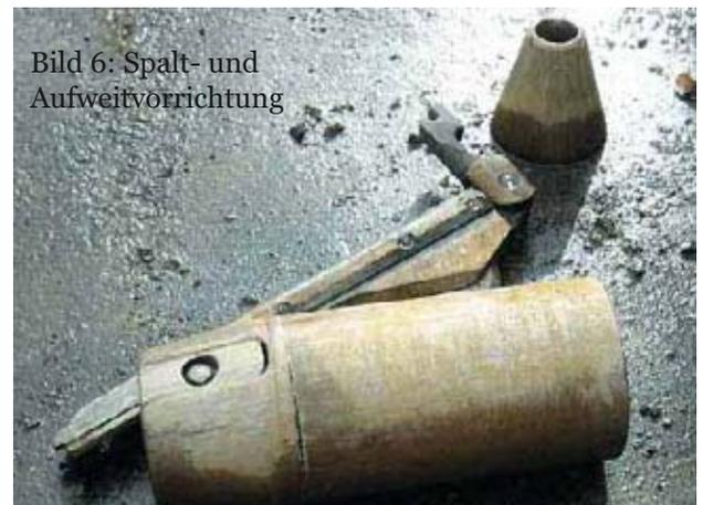
Bild 6: Spalt- und Aufweitevorrichtung
