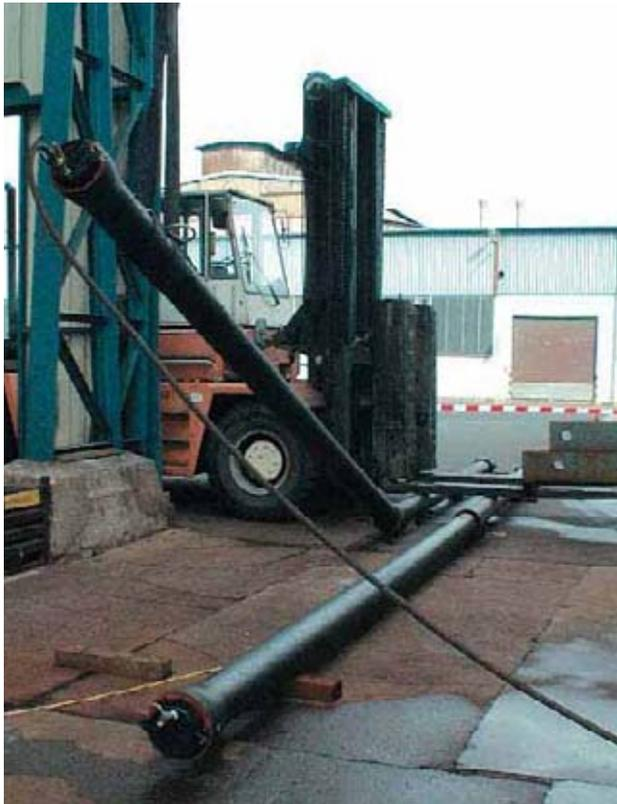
Bild 7: BLS-Verbindung mit Riegel
