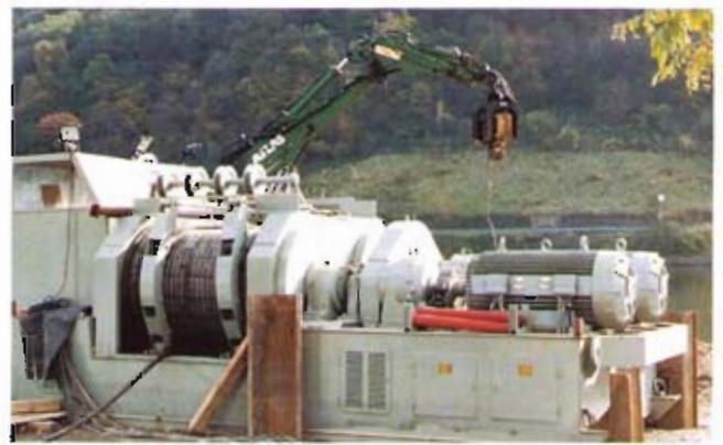
Bild 7: Diese Zugwinde hatte keine Mühe mit den erforderlichen 47 t Zugkraft.
