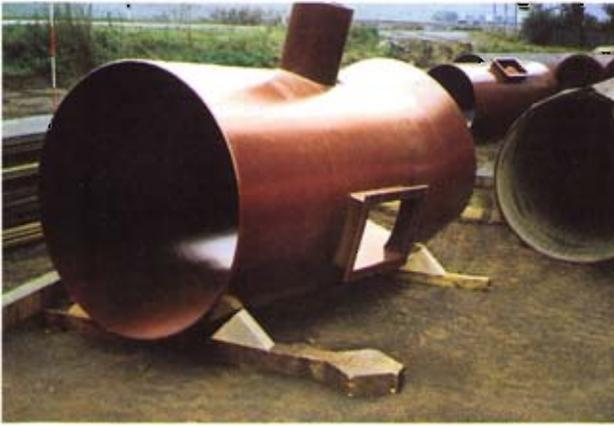
Bild 6: Aufgeschweißte Reinigungsöffnungen
