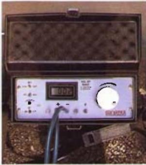
Bild 5: Druckanstieg nach 30 Minuten bei der Prüfung des Abwassersammlers, kontrolliert mit Differenzdruckmeßgerät
