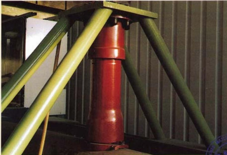
Abb. 6 Auf Rohr DN 600 sitzendes Hausanschlußstück DN 150.
