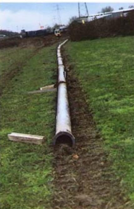
Bild 3: Rohr mit den stärksten Schabspuren in der Deckbeschichtung. Zinkschicht noch durchgehend vorhanden
