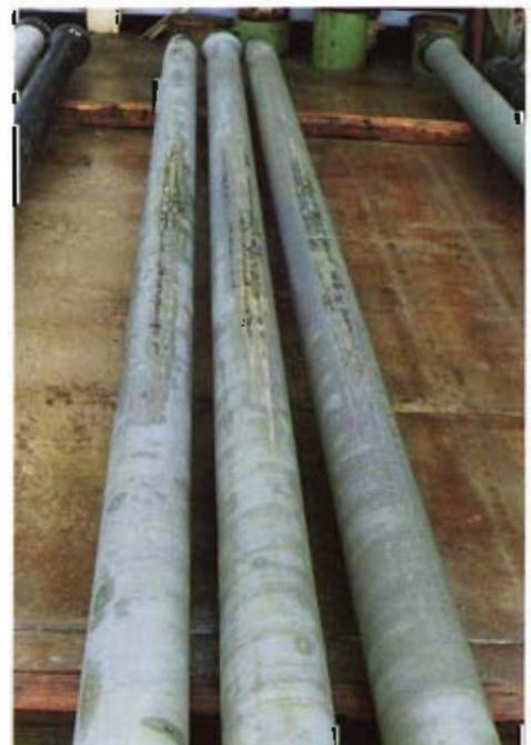
(Bild 5). Jede einzelne Verbindung ist um ca. 3° abwinkelbar, was bei 6 m Rohrlänge eine Abweichung von der Geraden von ca. 300 mm ausmacht.
