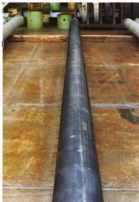
Bild 4: ZM-Umhüllung mit Schabspuren
