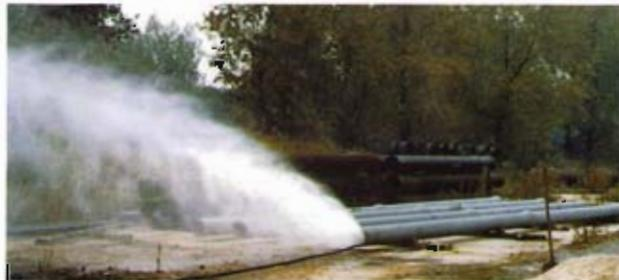
Tonerdezementmörtel-Auskleidungen werden meist in Abwasserrohren verwendet. Die Auswirkungen der mechanischen Angriffe von Druckstrahlen aus Hochdruck-Reinigungsgeräten auf die Schutzschicht wurden an duktilen Gußrohren DN 300 und DN 400 untersucht. Der Beitrag berichtet ausführlich über Durchführung und Ergebnisse dieser Untersuchung.
