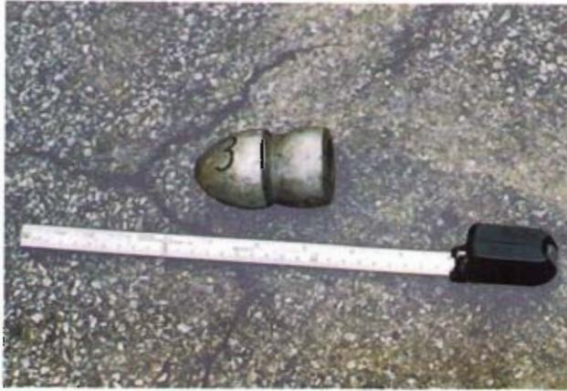
Bild 3: Runde Kanal- und Rohrreinigungsdüse
