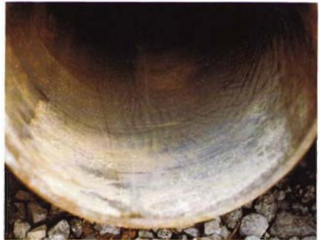
Bild 14: Schleifspuren vom Durchziehen der Düsenköpfe
