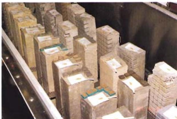
Bild 2: Eingesägte Probekörper und Rohrsegmente mit ZM-Auskleidung und beschichtetem Verbindungsbereich
