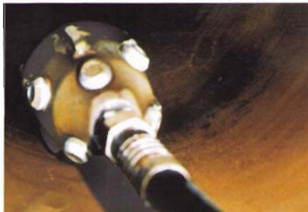
Bild 8: Runde Kanal- und Rohrreinigungsdüse mit aufgeschweißten Knaggen
