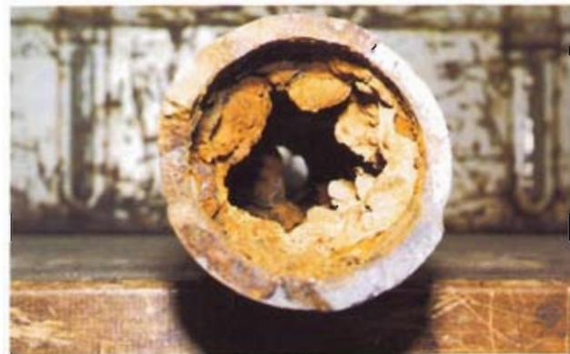
Bild 2: Inkrustation einer ca. 50 Jahre alten Wasserleitung
