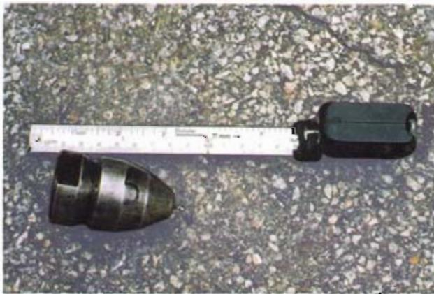
Bild 6: Runde Kanal- und Rohrreinigungsdüse
