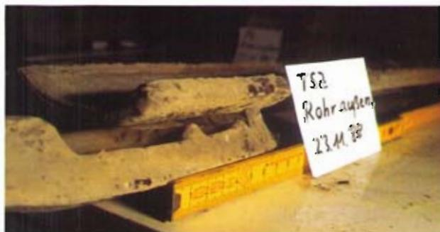
Um die Beständigkeit gegenüber biogener Schwefelsäure-Korrosion geht es in der Untersuchung, die an der Universität
