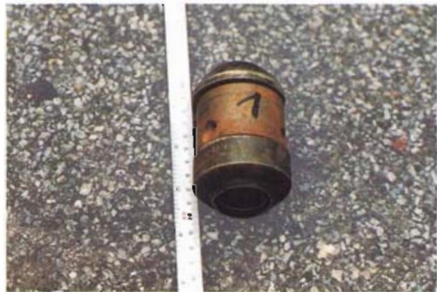
Bild 1: INT.ENZ MU Rotierdüse Ø 60 mm
