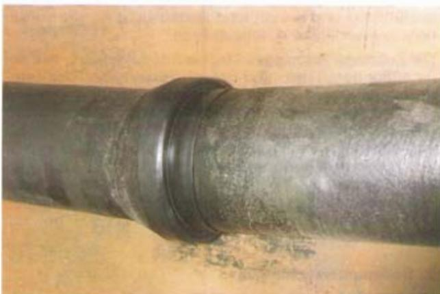
Bild 25: ZM-Schutzmanschette abgewinkelt
