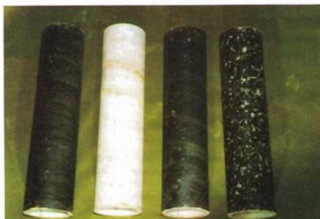
Bild 11: Einrüttelversuch
