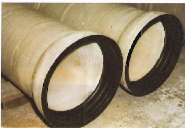
Bild 6: Bituminieren der Muffenstirnseite und des Muffeninnenprofils
