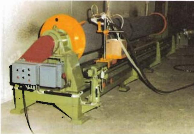
Bild 2: Drehmaschine mit Faserzement-Spritzpistole
