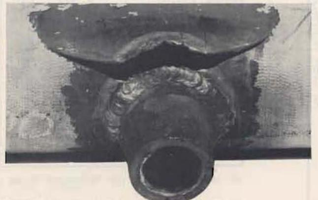
Bild 4: Berstdruck 300 bar, Wanddicke 5,0 mm
