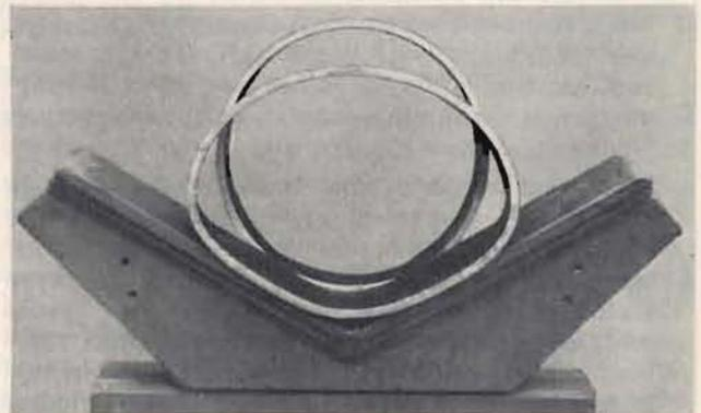
Bild 15: Verformung eines duktilen Rohres NW 200 beim Längsbiegeversuch an der Lastangriffsstelle (nach [4])
