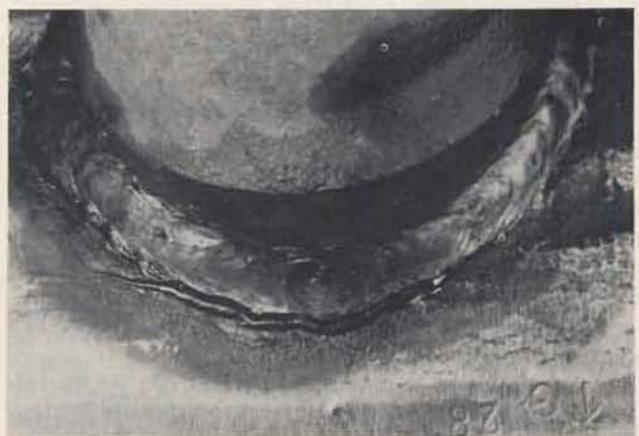
Bild 6: Rißverlauf beim Biegewechselversuch
