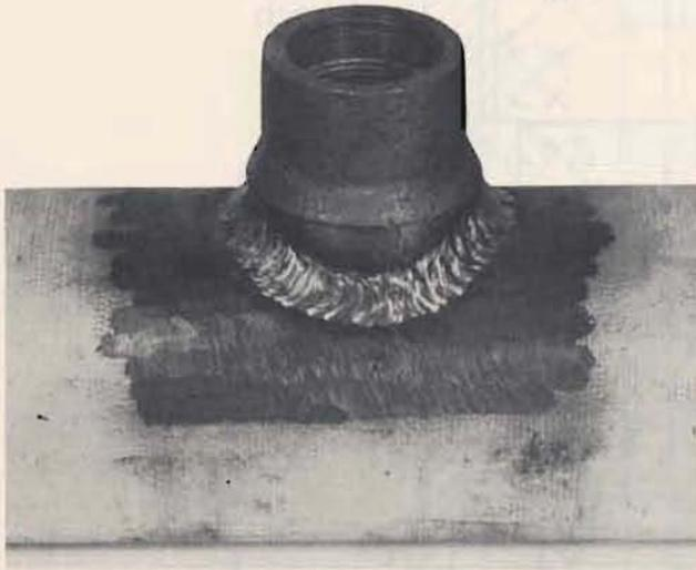
Bild 1: Angeschweißter Stutzen mit Decklage
