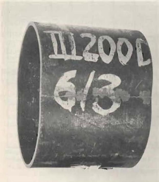
Bild 8: Duktiles Gußrohr NW 200 nach einem Scheiteldruckversuch ohne Innendruck (nach [3])
