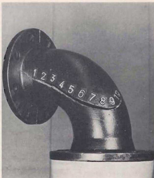
Bild 6: Q-Stück NW 100, Berstdruck 540 kp/cm<sup>2</sup>
