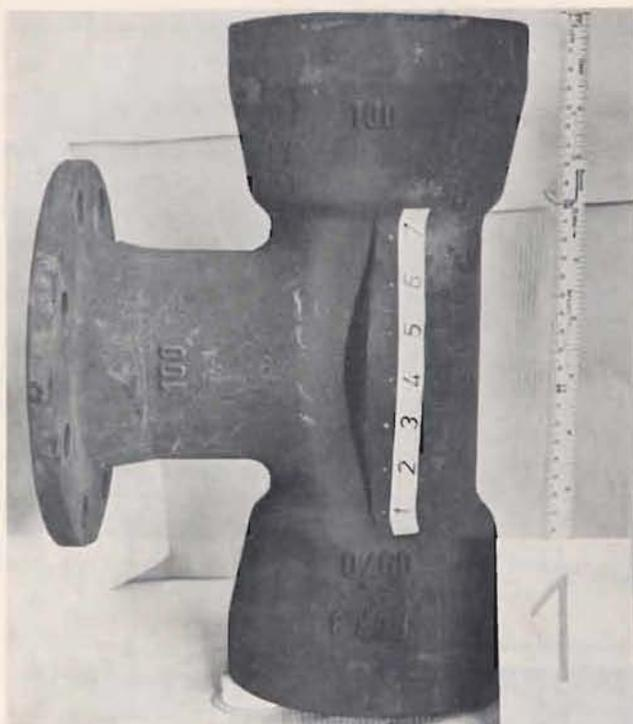
Bild 4: MMA-Stück NW 100 x 100, Berstdruck 370 kp/cm<sup>2</sup>
