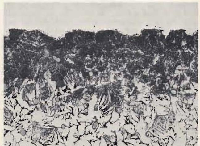
Bild 9: Mikroschliff Übergangszone Stutzen-Schweißung (x 1000)
