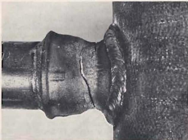
Bild 14: Bei Biegewechselprobe gebrochener, angeschweißter Stutzen
