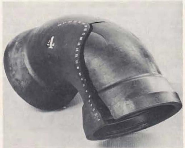
Bild 2: MMQ-Stück NW 300, Berstdruck  $200 \text{ kp/cm}^2$
