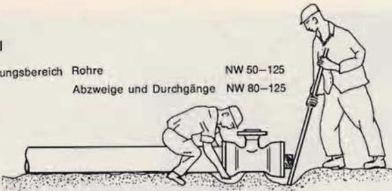
Bild 3: Einbau von TYTON-Formstücken mittels Hebel
