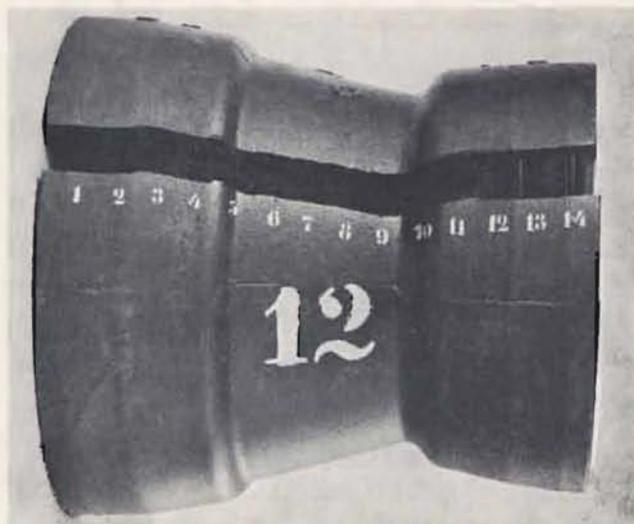
Bild 5: MMR-Stück NW 250 x 200, Berstdruck 240 kp/cm<sup>2</sup>
