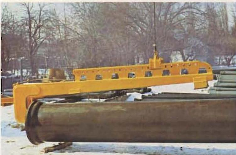
Bild 3: Verlegevorrichtung, in Rohr eingefahren, am Beginn des Anhebens
