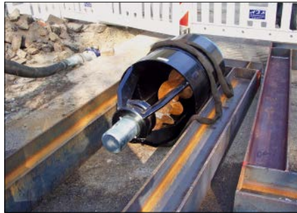
Bild 22.19: Zugkopf mit innenliegender Förderschnecke
