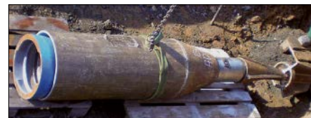
Bild 22.7: Berstkopf mit Rippen, Aufweitstufe und Zugkopf
