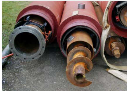
Bild 22.20: ZM-U-Plus-Kanalrohr mit eingebautem Förderrohr und Schneckengestänge
