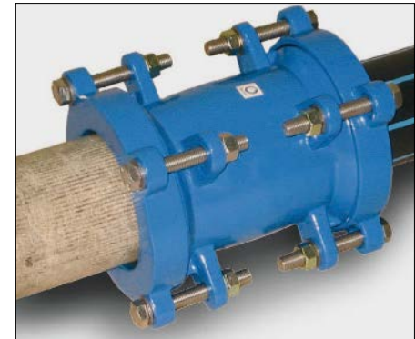
Bild 10.4: Großbereichs-Kupplung für Materialübergänge (links: Faserzementrohr, rechts: PE-Rohr) mit Schraubenbefestigung am Körper
