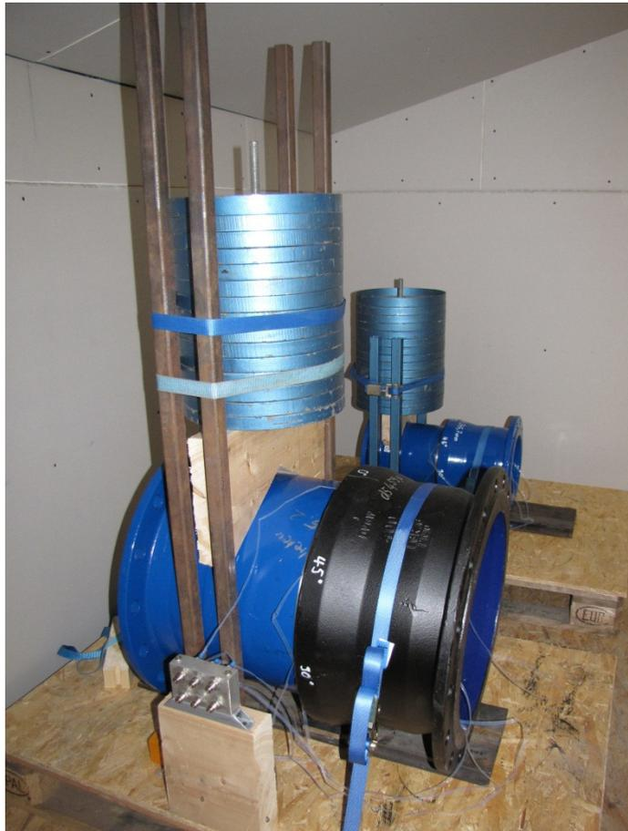
**Abb. 2:** Prüfaufbau DN 400 (vorne) und DN 200 (hinten)
